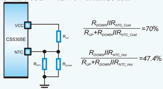
上面式中 $R_{NTC\_Cold}$ 为NTC电阻在设定的低温点所对应的阻值，而 $R_{NTC\_Hot}$ 为NTC电阻在设定的高温点所对应的阻值。由于 $R_{DOWN}$ 和 $R_{UP}$ 这两个电阻可以分别独立设定低温和高温窗口，使得CS5305E可以满足大部分NTC电阻型号，这为应用带来了极大的便利。电阻 $R_{DOWN}$ 和 $R_{UP}$ 与NTC电阻之间的关系可以通过上述定义给出下列公式：
